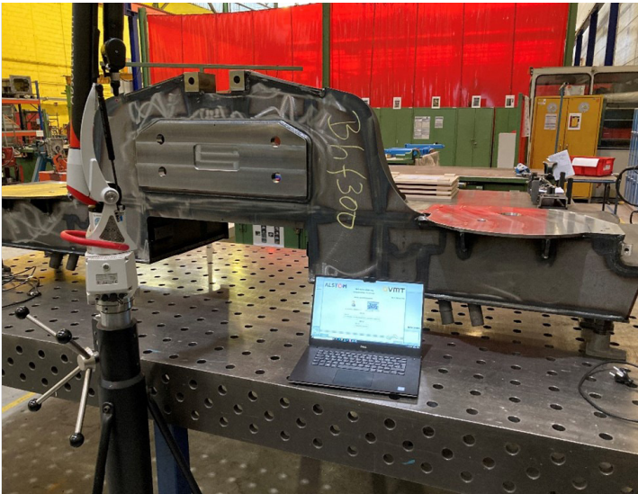
Endquerträger-Vermessung mit einem Messarm im ALSTOM Werk Salzgitter
