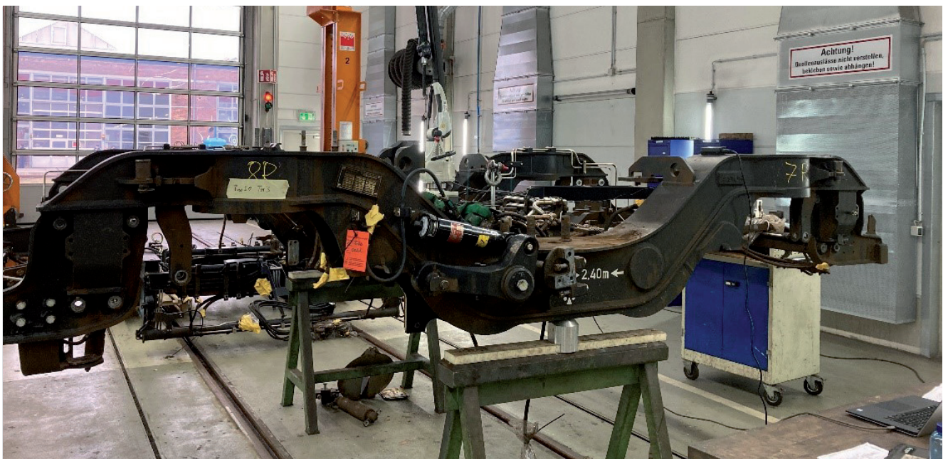
Drehgestellrahmen-Vermessung mit einem Messarm im DB Werk Nürnberg
