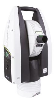
Der AT500 bietet Messungen auf Reflektoren auf bis zu 160 Metern, einen integrierten Controller und die Möglichkeit, mit der B-Probe<sup>plus</sup> zu messen.
