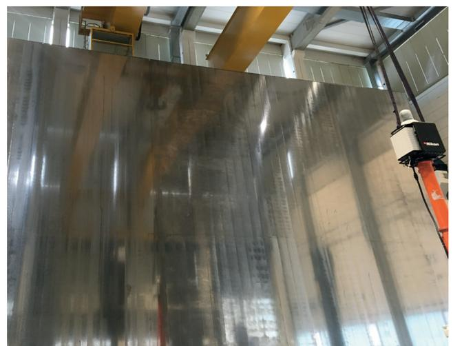
Abbildung 4: Frontalansicht auf den Reflektor mit davor aufgebautem Laser Radar
