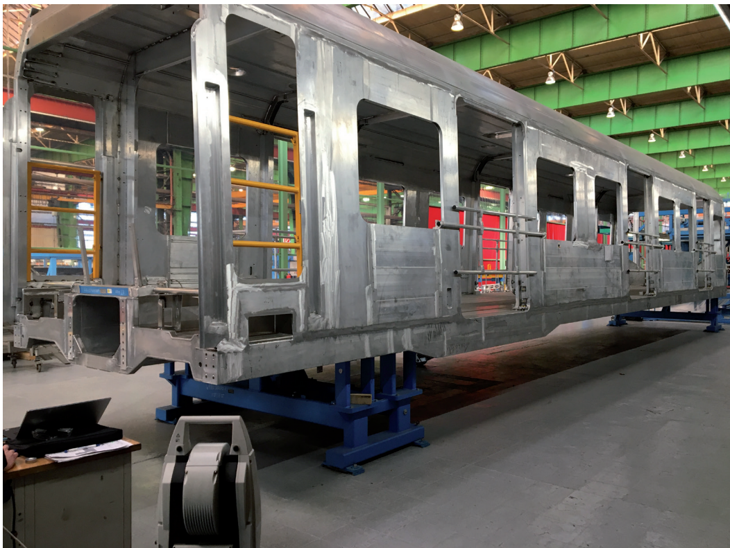
Abbildung 1: Wagenkasten-Rohbau der Baureihe 430 mit Lasertracker im Werk Salzgitter der ALSTOM Transport GmbH
